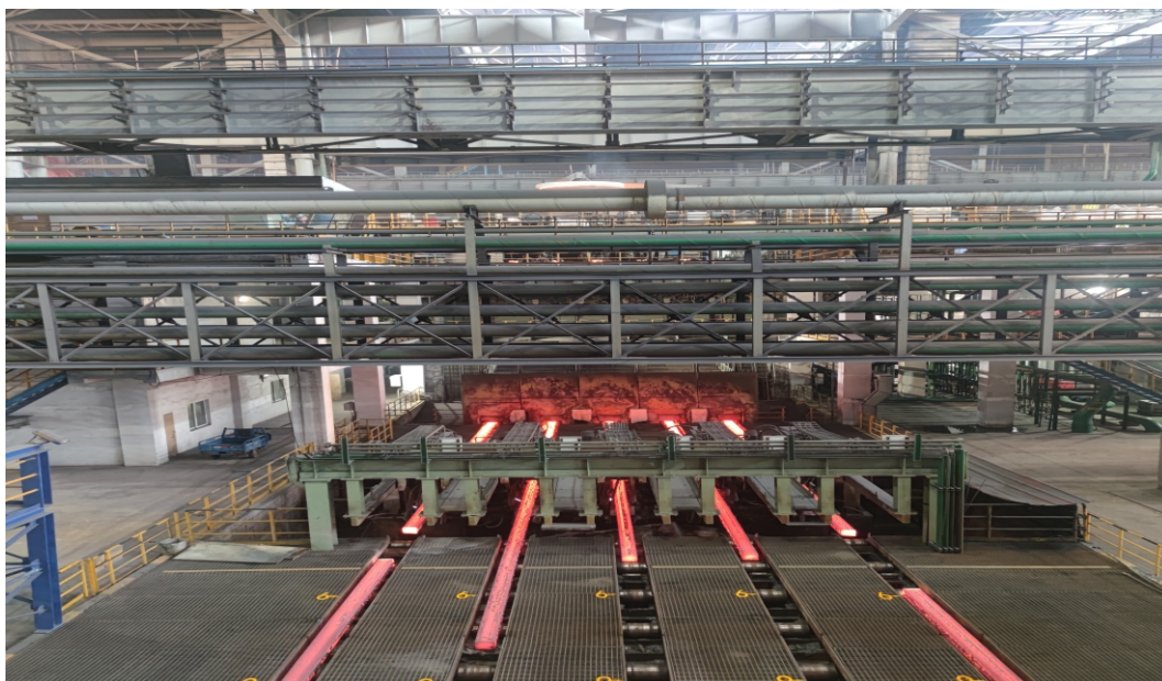
东方特钢厂七机五流方坯连铸机--高温高湿度环境下的速度检测
